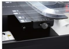
Der Heftanschlag lässt sich stufenlos von 3 bis zu 23 mm einstellen und durch diesen Drehknopf arretieren.
