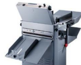
Die untere Falztasche ist gegen Rill- und Perforierwerkzeuge, inklusive einer separaten Ablage austauschbar (auch für schwere Papiere geeignet).
