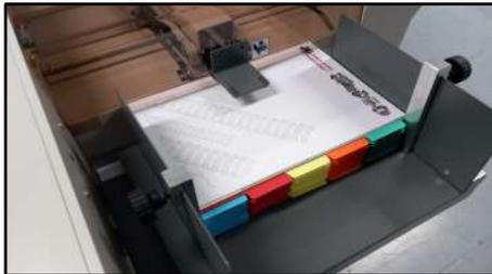
Einstellung des Anlegers mit magnetischen und verschiebbaren Anschlägen
